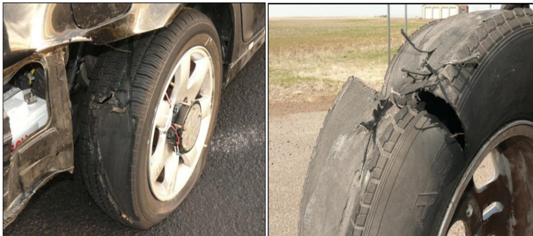
איור 27. צמיג בעקבות הפרדה מלאה עם אובדן אוויר לא מכוון. איור 28. צמיג בעקבות הפרדה חלקית שנגררה עם אובדן אוויר.
