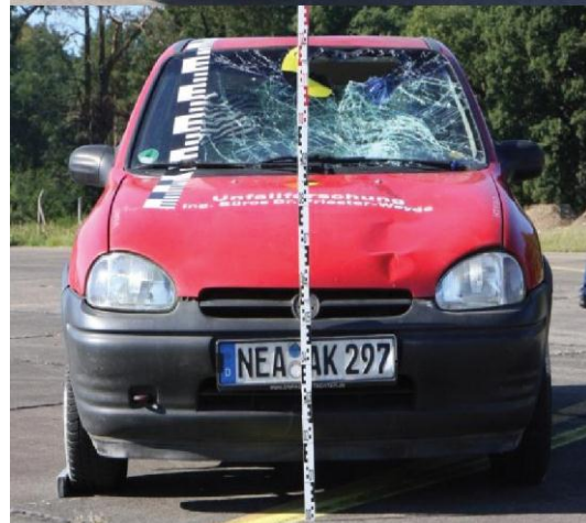
תמונה 25 ו- 28 –הנזק שנגרם לרכב (אופל כורסה) בפגיעה בבובת דמי במהירות 53 קמ"ש.
