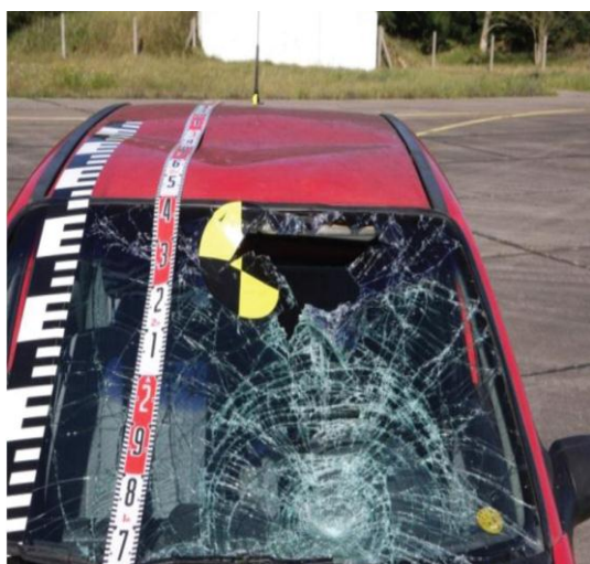
תמונה 25 ו- 28 –הנזק שנגרם לרכב (אופל כורסה) בפגיעה בבובת דמי במהירות 53 קמ"ש.
